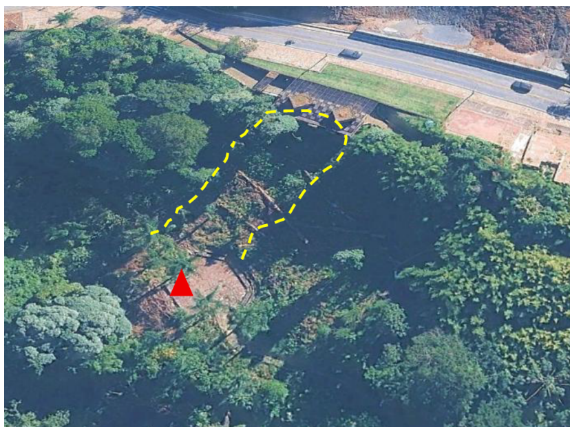
Figura 6-19 Triângulo vermelho identifica o anfiteatro e a linha pontilhada amarela marca a zona de deslizamento.
