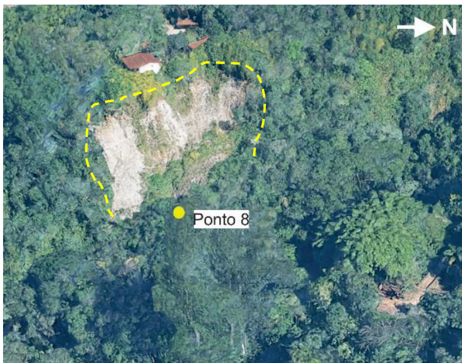
Figura 6-24 linha tracejada destaca o antigo deslizamento próximo do ponto.
