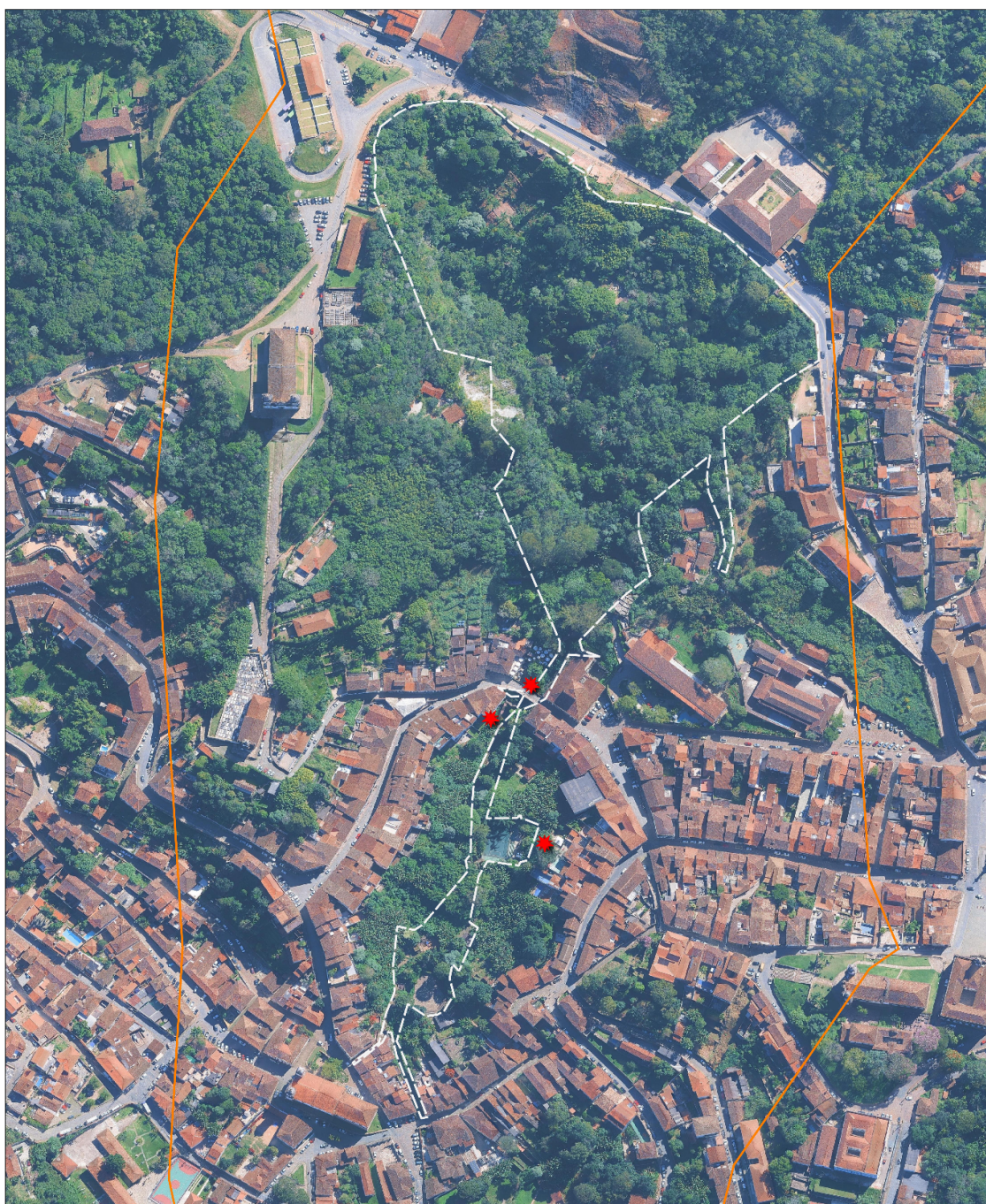
Figura 5-1 Pontos relatados de vazamento de esgoto
