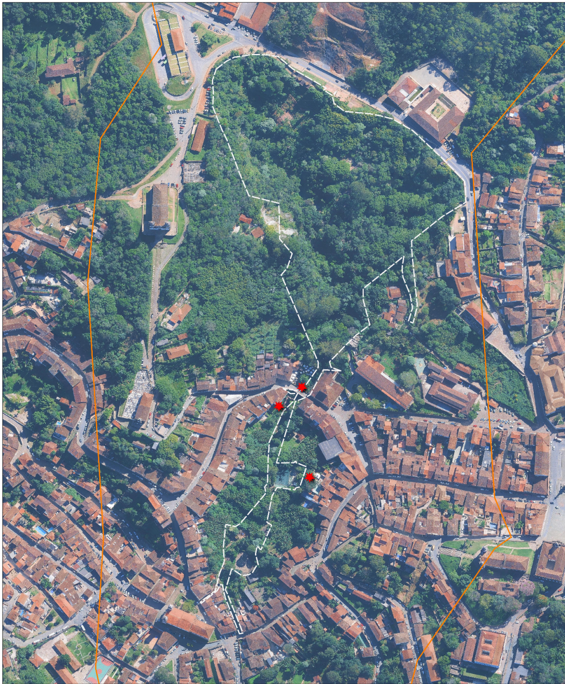
Figura 2-17 Pontos relatados de vazamento de esgoto
