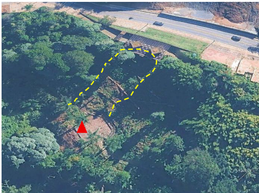
Figura 5-19 Triângulo vermelho identifica o anfiteatro e a linha pontilhada amarela marca a zona de deslizamento.
